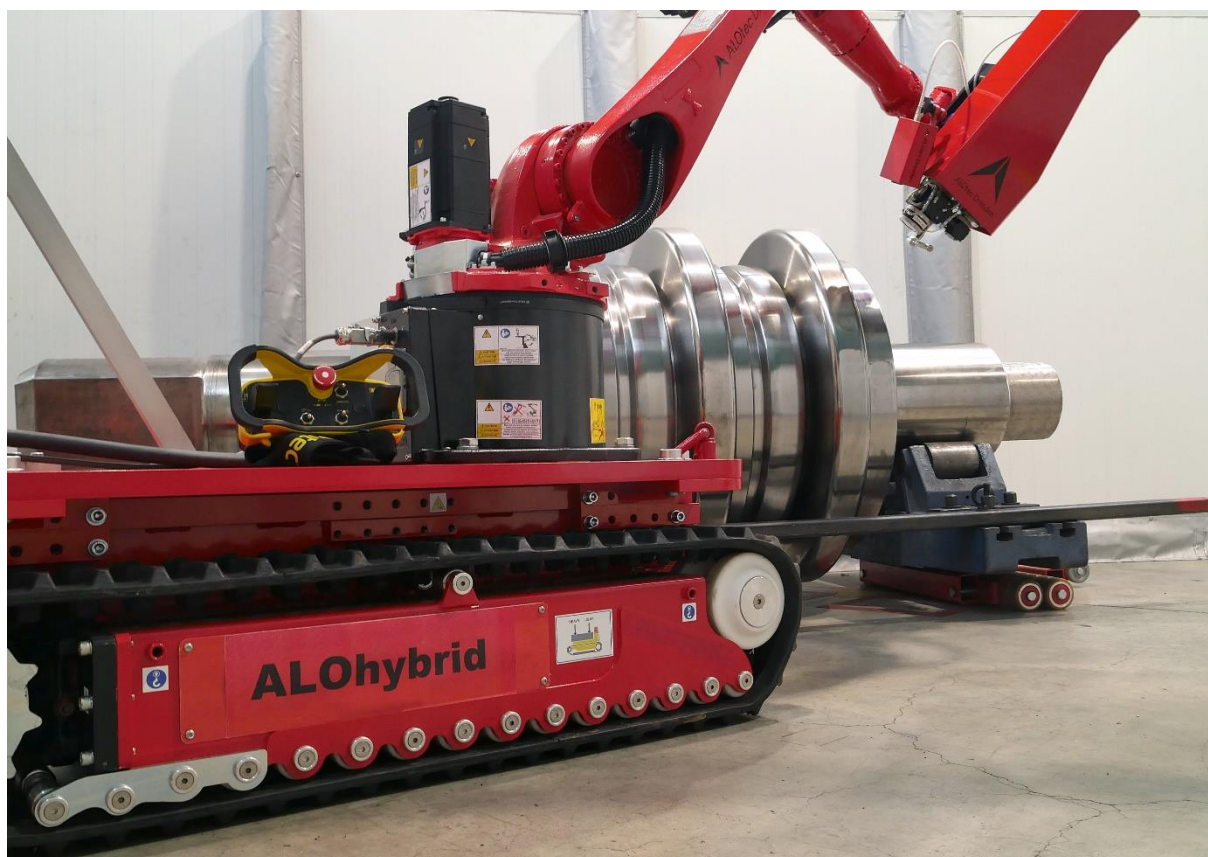
Bild: Laserhärten einer Welle mithilfe der mobilen ALOhybrid-Konfiguration. ©ALOtec Dresden GmbH
