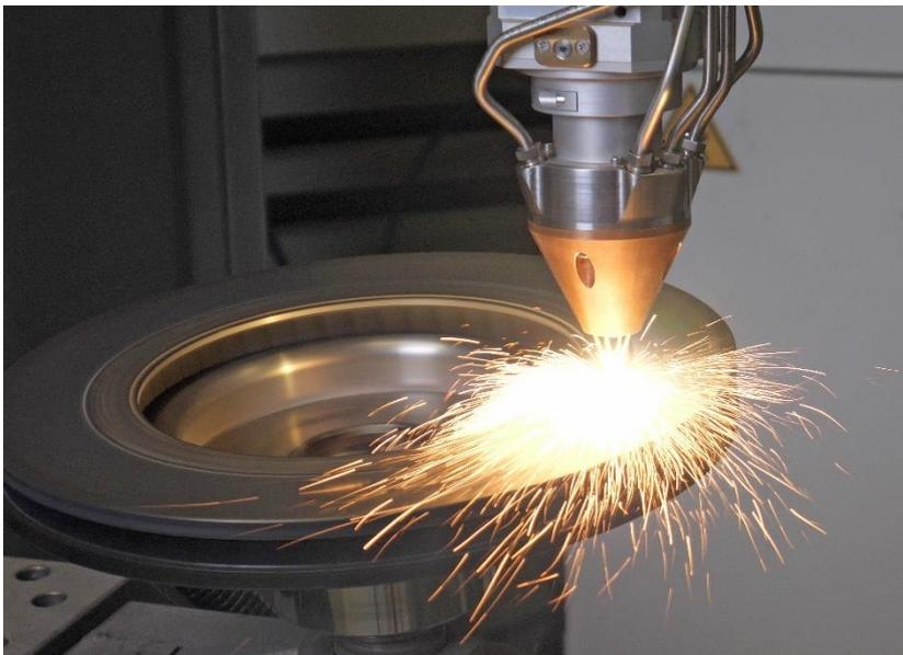
**Bild 3: Pulverbasierte Laserbeschichtung einer Bremsscheibe. ©Laserline**
