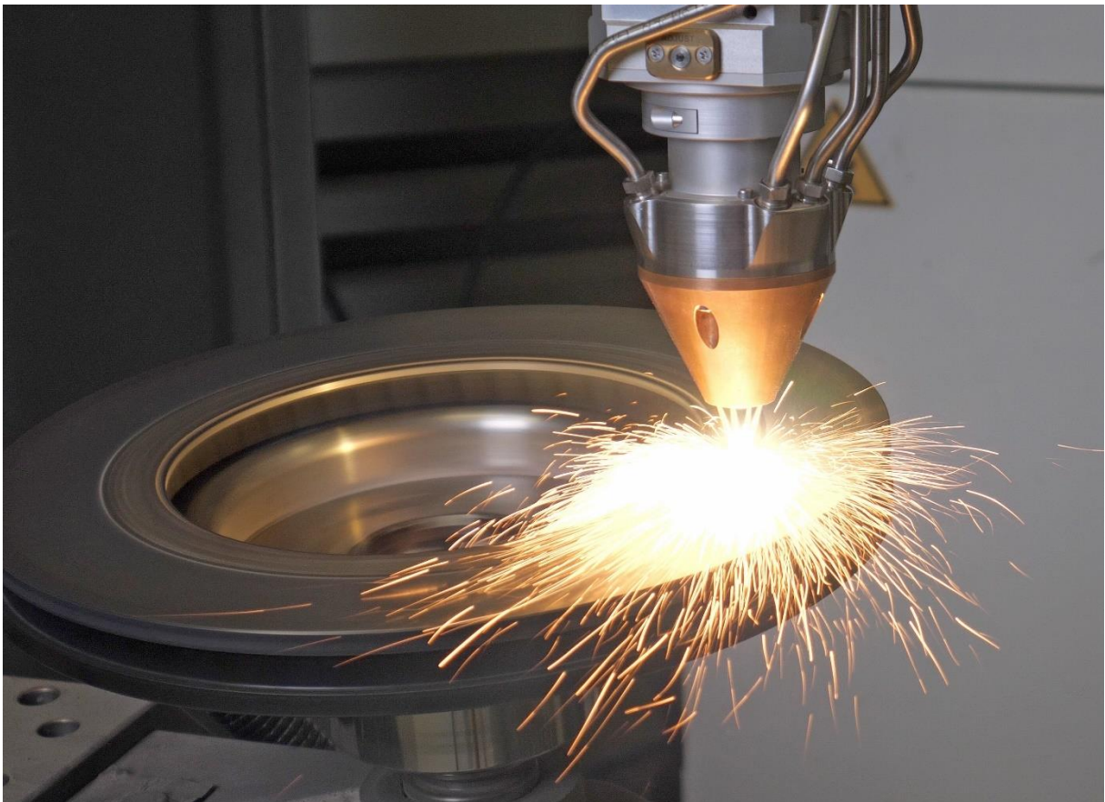
Bild 2: Pulverbasierte Laserbeschichtung einer Bremsscheibe. ©Laserline
