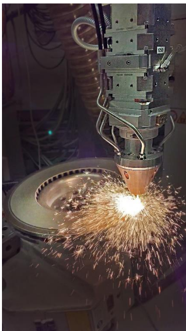
Bild 2: Pulverbasierte Laserbeschichtung einer Bremsscheibe. ©Laserline
